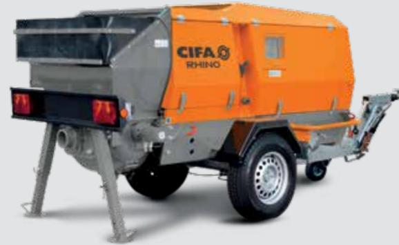
RHINO est une pompe à double piston avec une valve en S et un débit variable pour le béton projeté, le micro-béton, et le béton spécial. RHINO est un choix fiable sur les chantiers étroits. Cette pompe à béton sur remorque est conçue pour des applications mécanisées de béton projeté humide en association avec le MANTIS ou pour des applications manuelles avec une buse de pulvérisation.
