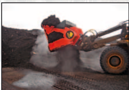
Aération du compost
