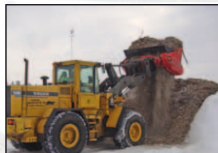
Aération des déchets organiques
