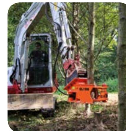
La tête de coupe Woodcracker® CL 190 a été conçue spécialement pour la récolte facile du bois d'un faible diamètre, jusqu'à 25 cm.
