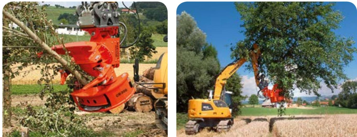
La Woodcracker® CB a été conçue spécialement pour la récolte rapide des petits arbres et arbustes jusqu'à un diamètre de 35 cm. La dépose automatique innovante et la synchronisation des commandes permettent une récolte rapide.
