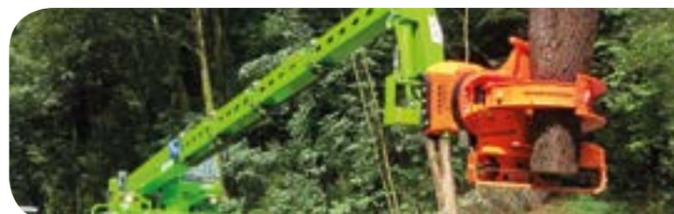
Woodcracker CS 580 smart est grâce à son faible poids l'outil idéal pour montage sur chargeur télescopique ou grue télescopique. Démontage des arbres spécifiques par exemple au long des jardins ou dans les villes sont à faire sans problème avec cette machine.
