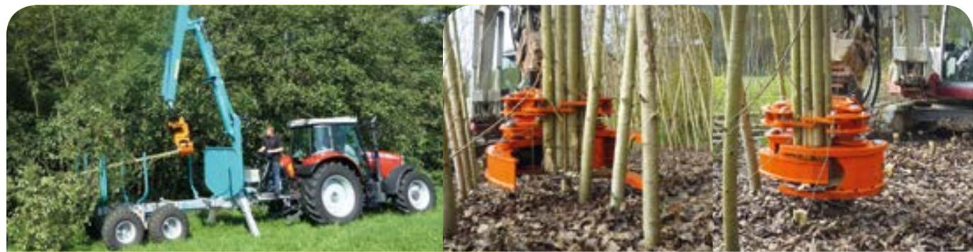
La tête de récolte bois énergie CB150 a été spécialement conçue pour la récolte facile du bois faible jusqu'à un diamètre de 25 cm. Le domaine d'application principal est dans la récolte de bois énergie et plantation à courtes rotations.
