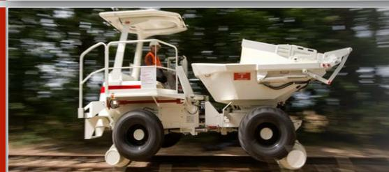
3 vitesses sur rail, jusqu'à 21 km/h
