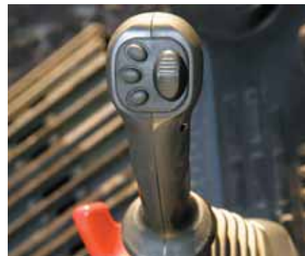
Leviers avec boutons de commande proportionnels pour les accessoires
