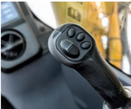
Manipulateurs avec boutons de commande proportionnels pour les accessoires
