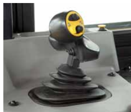
Système ergonomique PCCS (Palm Command Control System) avec levier de contrôle de la lame automatique/manuel
