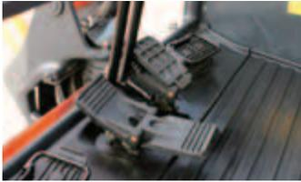
Tout en déplaçant la machine avec les pieds, l'opérateur peut commander manuellement l'accessoire situé à l'avant. Les pédales, si elles ne sont pas utilisées, peuvent être repliées pour maximiser l'espace réservé aux pieds.
