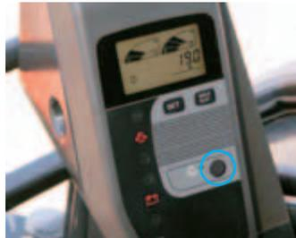
En plaçant le levier de vitesse au point mort, le régime moteur passe au ralenti pour réduire la consommation de carburant ainsi que les émissions et le bruit. Cette fonctionnalité est un véritable plus pour les travaux dans les zones résidentielles urbaines.
