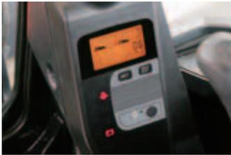
L'opérateur peut contrôler à tout moment l'état de la machine, d'un simple coup d'œil. Niveau de carburant, température du liquide de refroidissement et statuts de divers autres indicateurs sont clairement affichés sur le grand écran à cristaux liquides, situé sur la partie avant droite.
