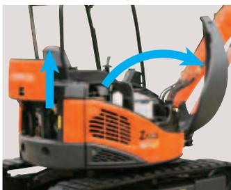
Le capot du moteur s'élève et s'abaisse en pivotant pour accélérer l'entretien, même dans des espaces confinés. Fini les capots rabattables gênant les opérations de maintenance et d'entretien. Le capot de droite s'ouvre en pivotant pour faciliter le contrôle de la batterie.
