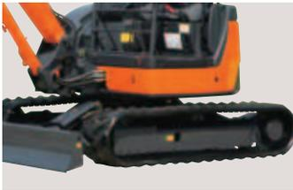
Pour un déplacement accéléré, lorsque la charge augmente, ainsi pour tourner, la vitesse de marche est réduite automatiquement et progressivement. Lorsque la charge est réduite, la vitesse de marche est rétablie.
