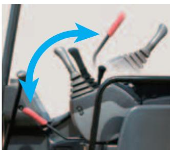
Toutes les opérations - équipement avant, rotation, déplacement et lame - peuvent être neutralisées en bloquant la soupape de neutralisation des commandes de pilotage. Ceci empêche efficacement tout actionnement accidentel des commandes.
