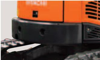
En cas d'utilisation d'un accessoire assez lourd à l'avant, ainsi une pince de maintenance, le contrepoids additionnel est facile à monter pour optimiser la stabilité.
