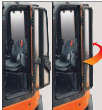
La porte s'ouvre en deux temps et présente une ouverture élargie de 610 mm, facilitant l'entrée et la sortie.
