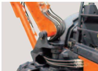
Les flexibles avant à sections sont couplés aux orifices du capot de la machine et à l'arrière de la flèche pour faciliter leur remplacement.
