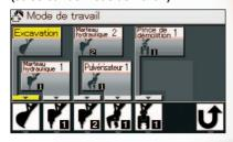
Quand on change d'outil, le réglage du débit d'huile peut être réalisé automatiquement par sélection du mode de travail sur le moniteur LCD. Des ajustements mineurs du débit sont possibles si besoin est.
