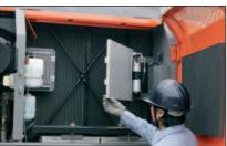
Le refroidisseur d'huile, le radiateur et l'échangeur sont diposés en parallèle au lieu de l'installation conventionnelle en série. Cette disposition en parallèle offre d'importants avantages quant au nettoyage autour du moteur. Le condensateur du climatiseur s'ouvre pour permettre de nettoyer facilement le condensateur et le radiateur placé derrière.
