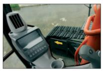
Le moniteur couleur à cristaux liquides, placé dans la cabine, indique la température du liquide de refroidissement, le niveau de carburant et certaines données d'entretien. Il permet aussi le réglage tactile de l'outil. L'écran peut également être réglé pour le travail de jour ou de nuit.
