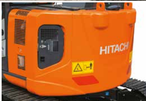
Le petit rayon de rotation garantit l'adaptation de la machine ZX135US-6 aux espaces exigus.
