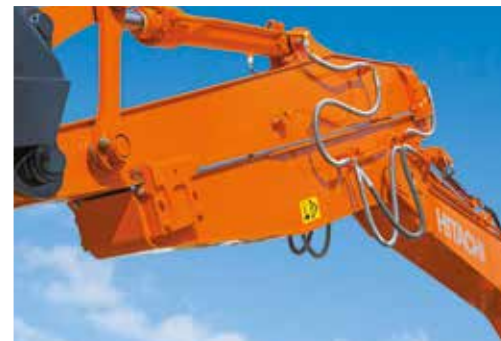
Le bras coulissant étend la plage de travail de la machine ZX135US-6.
