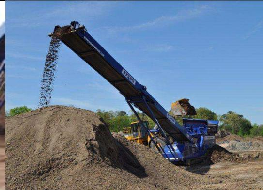
La gamme FS de convoyeurs mobiles EDGE, grâce à sa large trémie, peut être alimentée directement par une chargeuse ou une excavatrice. Cela permet de contrôler le flux de matériaux et de réduire les coûts de déplacement. Disponibles sur pneus (FMS) ou sur chenilles (FTS), ces convoyeurs sont idéals pour stocker vos matériaux, alimenter un concasseur ou même charger des navires.
