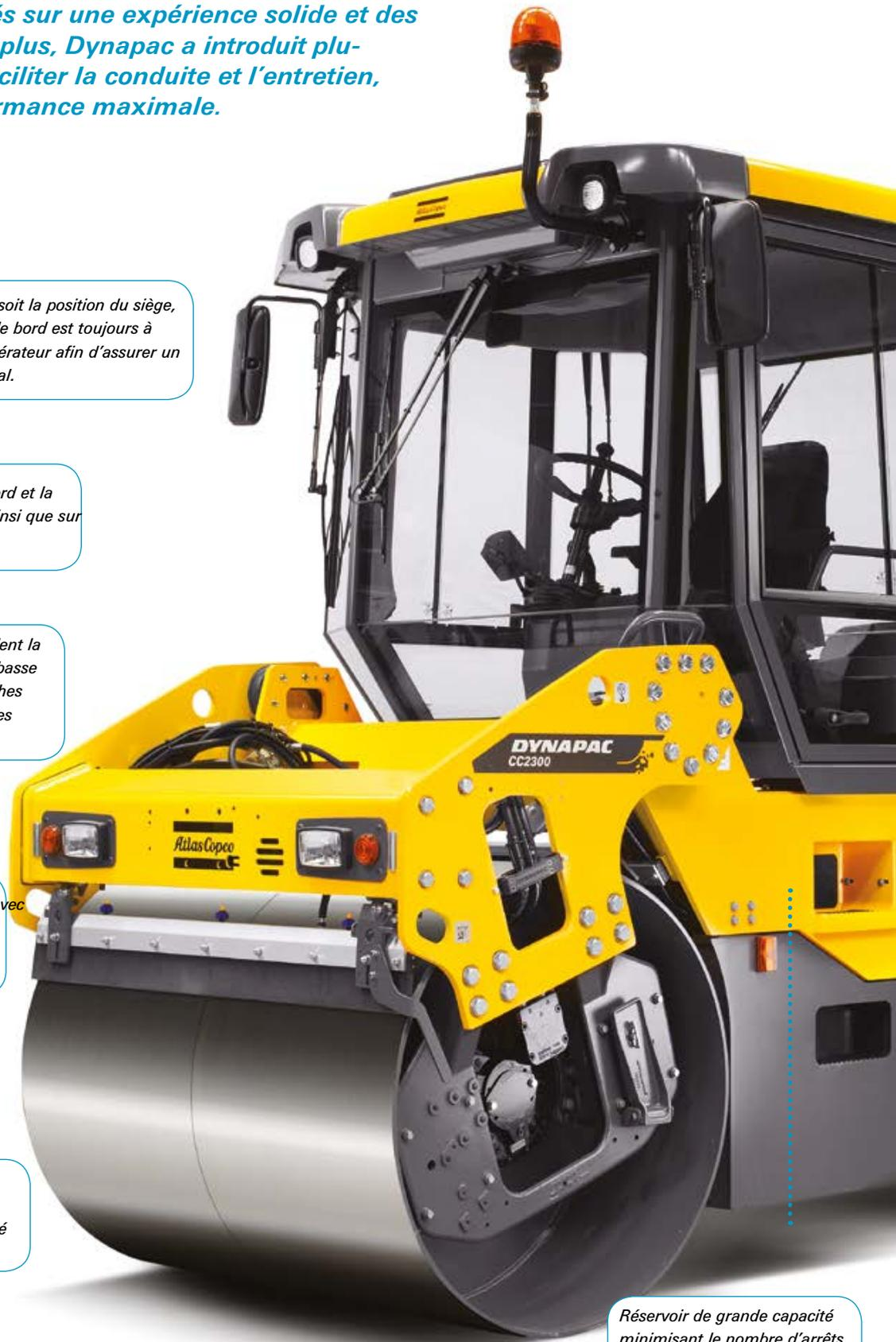
*Le travail de nuit est plus facile grâce à l'éclairage sur les bords de cylindre et à une lampe de lecture pour l'opérateur (en option).*
