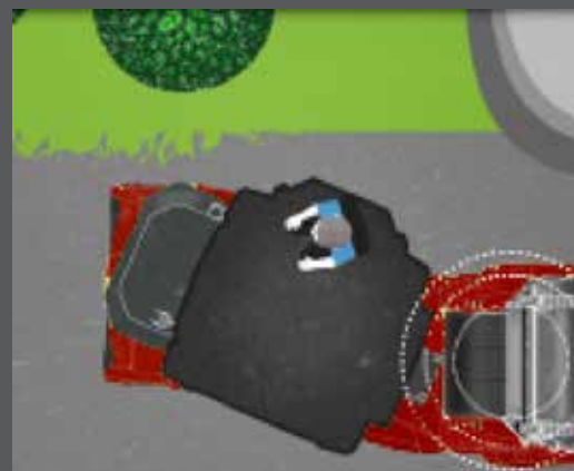
COMPACTAGE LE LONG DES ACCOTEMENTS Le long des accotements vous pouvez maintenir le poids de la machine au plus près du centre de la route.
