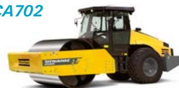
Le CA702 est le rouleau vibrant de compactage des sols le plus lourd de la gamme Dynapac. Il a été spécialement développé pour réaliser le compactage à grand rendement sur les sols, les enrochements et tous les types de matériaux. Les applications classiques incluent les barrages, les aéroports, les ports et les grands projets ferroviaires et routiers.
