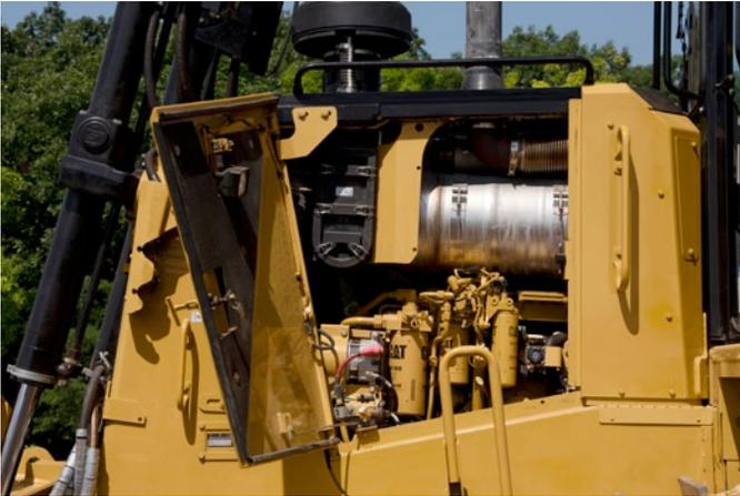
Sur le modèle D8T, la technologie de réduction des émissions est conçue pour fonctionner de manière transparente ; elle ne nécessite aucune intervention du conducteur. La régénération s'effectue automatiquement en arrière-plan tout au long du travail.
