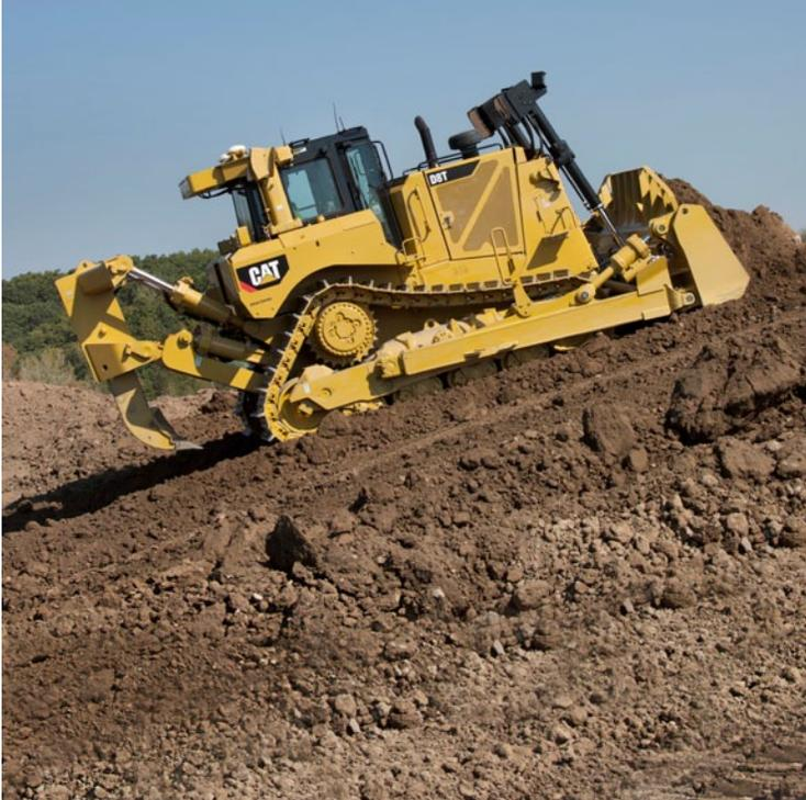
Le châssis principal du D8T est conçu pour absorber les chocs violents et résister aux forces de torsion. Le train de roulement entièrement suspendu augmente la surface de contact avec le sol, notamment sur terrain dur et accidenté. Il offre une meilleure traction pour moins de patinage, un meilleur équilibre et une conduite plus souple.
