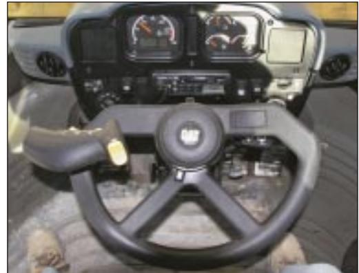
L'articulation complète de la machine est obtenue avec  $\pm 70^\circ$  de rotation du volant de direction - contre deux à trois tours de  $360^\circ$  pour un volant de direction classique. Le volant avec commandes de transmission intégrées contient le contacteur de marche avant/point mort/marche
