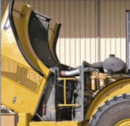
**Accès au compartiment moteur.** Le capot non métallique de la 980H a été redessiné et remodelé par rapport aux précédents modèles. Les panneaux latéraux et supérieur sont plus robustes grâce aux nervures de renfort plus solides; la modification de la forme du capot renforce encore sa rigidité. Les panneaux situés derrière les pneus se relèvent et peuvent être déposés pour un accès supplémentaire. Les garde-boue pivotent depuis l'arrière pour faciliter l'accès au compartiment moteur.
