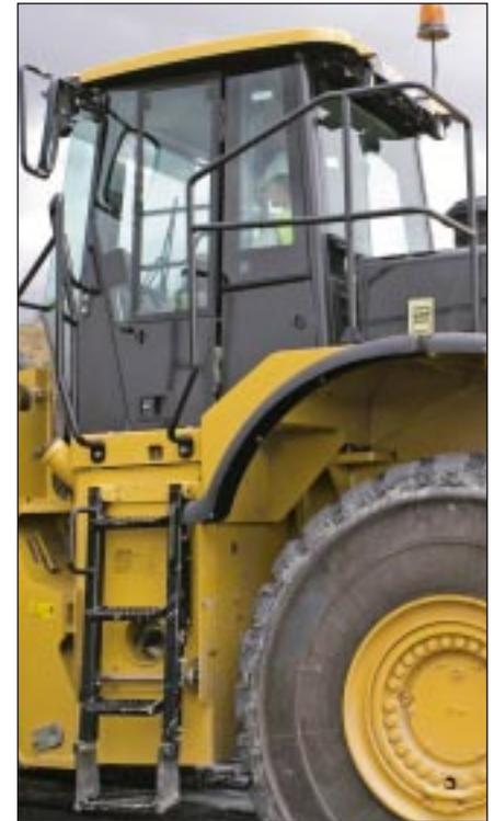
**Accessoires pour le nettoyage du pare-brise.** Les accessoires de nettoyage du pare-brise en option incluent des marchepieds et des mains courantes supplémentaires afin de faciliter l'accès pour le nettoyage des vitres avant.
