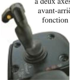
(FRAC). Cette commande règle automatiquement l'angle du godet pendant le levage pour qu'il reste constant.
