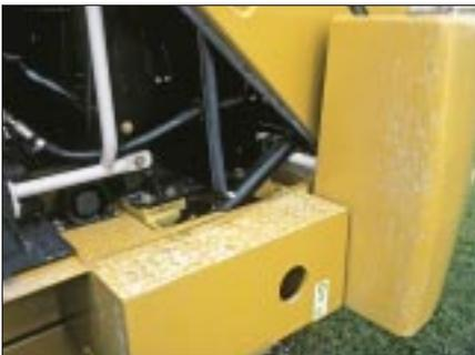
Le capot inclinable offre un très bon accès au compartiment moteur et, au besoin, l'ensemble du capot peut être déposé avec les points de levage intégrés.
