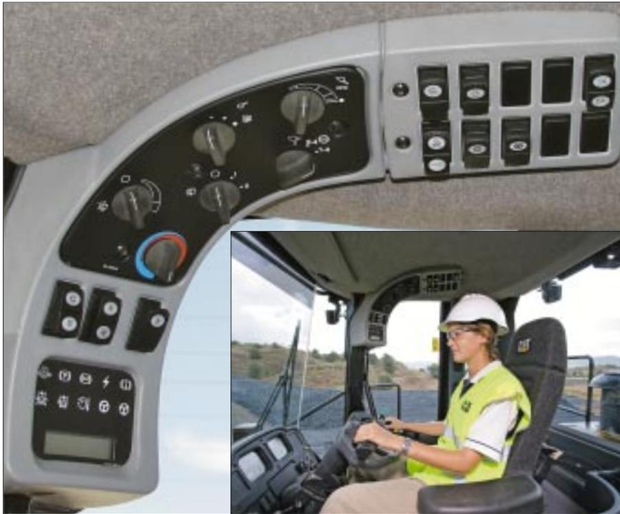
arrière et le bouton de montée des rapports/rétrogradation, permettant à la main gauche de rester sur le volant de direction à tout moment. La colonne de direction s'incline à 35° et permet un réglage télescopique de 100 mm.
