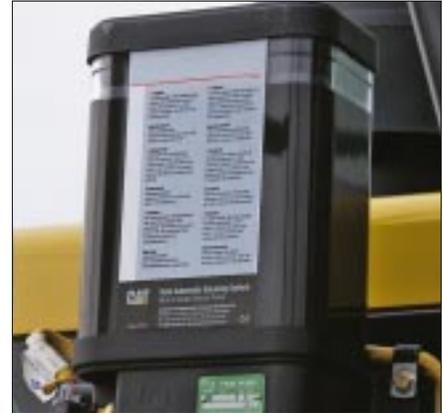
**Graissage automatique.** La durée de l'entretien quotidien est réduite et les immobilisations pour des réparations imprévues dues à un graissage inapproprié sont limitées grâce au système de graissage automatique Caterpillar (en option). Le graissage précis des axes et des bagues à intervalles spécifiques prolonge la durée de vie des composants et réduit la contamination du sol due à un graissage excessif.
