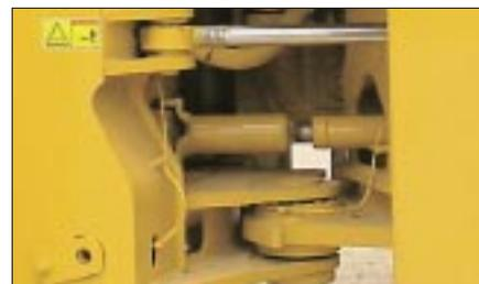
durée des roulements. Les pivots supérieur et inférieur pivotent sur des roulements à galets coniques doubles, ce qui améliore la longévité en répartissant les charges verticales et horizontales sur une surface plus grande. La large ouverture offre également un excellent accès pour l'entretien.
