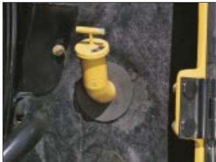
Capot fermé, des contrôles rapides du niveau d'huile moteur et du regard de niveau de liquide de refroidissement peuvent être effectués par les portes d'entretien latérales.
