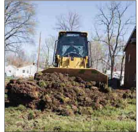
Le circuit de transmission hydrostatique à gestion électronique adapte automatiquement la vitesse de translation aux charges combinées de translation et d'équipement de la machine, optimisant de la sorte la vitesse de translation jusqu'à la vitesse sélectionnée par le conducteur.
