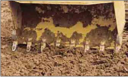
**Godet standard.** Le godet standard est conçu pour des chargements faciles et une longue durée de service dans des applications telles que les terrassements difficiles, le décapage et le chargement par reprise au tas. L'acier spécial haute résistance protège le godet contre les entailles et l'abrasion.
