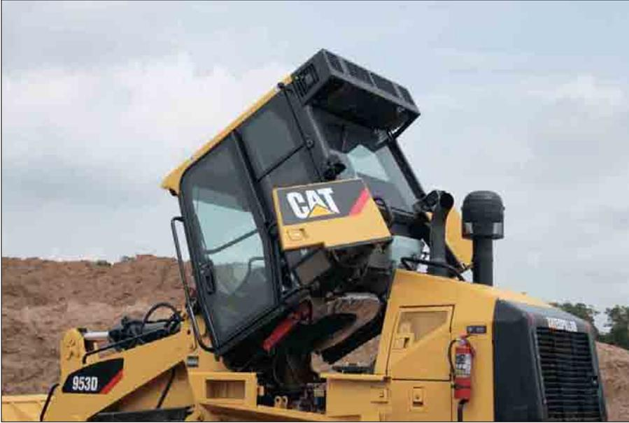
**Cabine basculante.** La 953D est équipée d'une cabine basculante. Cette caractéristique facilite grandement l'entretien et les réparations. En effet, en inclinant la cabine, vous accédez à la chaîne cinématique et pouvez effectuer l'entretien complet du circuit hydraulique.
