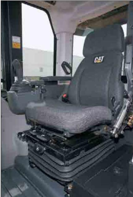
**Siège à suspension pneumatique Caterpillar.** Le siège à suspension pneumatique Caterpillar est ergonomique et entièrement réglable pour garantir un confort de conduite optimal. La ceinture de sécurité à enrouleur a une largeur de 75 mm pour un maintien à la fois sûr et confortable.
