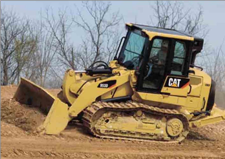
**Commandes d'équipement électro-hydrauliques.** Les commandes d'équipement électrohydrauliques de la 953D permettent au conducteur de contrôler avec souplesse, douceur et précision le godet et les bras de levage. Avec elles, le conducteur peut également régler des paramètres personnels tels que la réactivité de l'équipement (à l'aide du système Messenger, en option).
