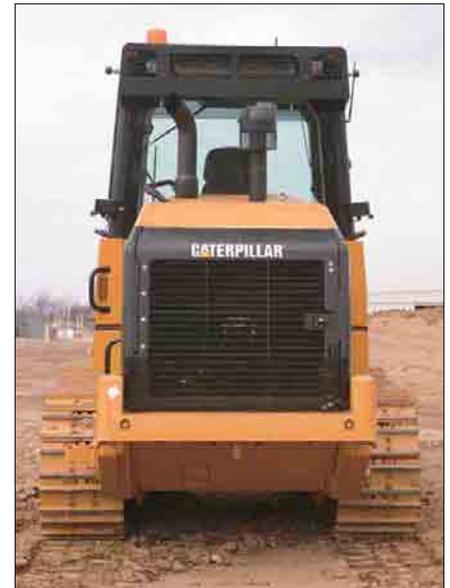
**Emplacement du moteur à l'arrière.** Le moteur est monté à l'arrière pour une excellente visibilité vers l'avant; il fait en même temps office de contrepoids naturel. Autres avantages: moins de risques de colmatage du radiateur et accès plus facile au moteur et aux principaux organes.
