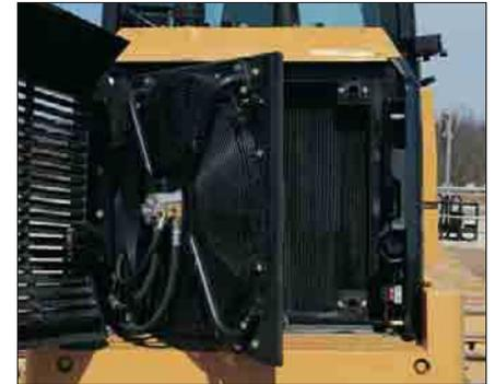
**Circuit de refroidissement.** Le ventilateur et la grille s'ouvrent en pivotant vers l'extérieur, offrant un excellent accès pour les opérations de nettoyage et d'entretien. La grille verrouillable extra-robuste minimise les accumulations de débris.
