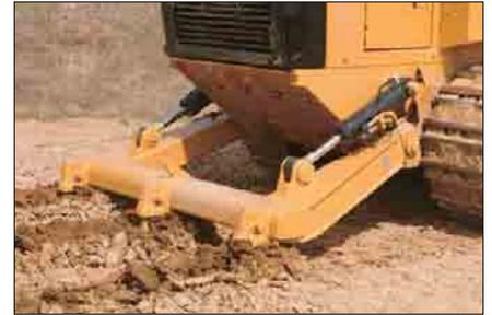
**Ripper-scarificateur.** Un ripper-scarificateur radial peut équiper la Chargeuse 953D. Il se monte avec deux axes pressés dans chaque longeron du châssis principal. Deux vérins relèvent et abaissent le ripper. La traverse de ripper comporte trois poches pour maintenir les porte-dents. Les six axes de la timonerie ne nécessitent pas de graissage.
