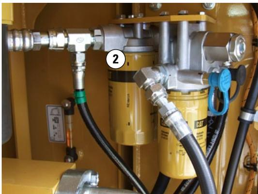
Les pelles hydrauliques Cat offrent un niveau supplémentaire de prévention des contaminations grâce au filtre de vidange (2). Situé dans le compartiment de la pompe, derrière le filtre pilote, le filtre de vidange purifie le retour au carter des pompes principales, du moteur d'oscillation et des moteurs de translation. Ainsi, il améliore la durée de vie des pompes et des moteurs, ainsi que le temps productif.
